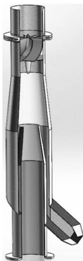
Рис. 1. Запатентованная конструкция прямоточного циклона
